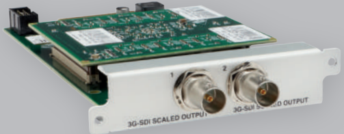
Двухканальный модуль выхода 3G-SDI с масштабированием
