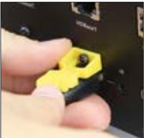
2 Наденьте LockPro™ на ослабленный винт
