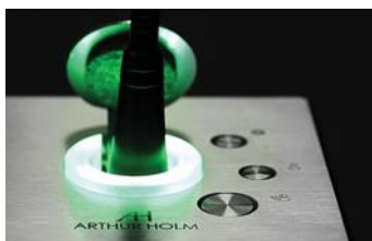
Светодиодная подсветка в форме кольца показывает статус посредством изменения цвета от зеленого до красного
