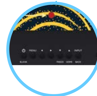
Горячие клавиши Управление громкостью, разъемы для подключения устройств, а также доступ к функциям Blank (пустой экран) для затемнения экрана и Freeze (заморозка) для паузы в работе экрана – располагается на передней части панели
