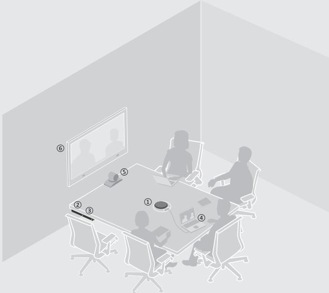
Переговорная «Аквариум» предназначена для проведения встреч в команде и совместной работы с удаленными коллегами. Для обеспечения высококачественного звука на дальнем конце ANIUSB-MATRIX направляет звук с Настольного Микрофонного Массива Microflex Advance MXA310 в систему видео-конференц-связи или в программный кодек, установленном на собственном устройстве участника. Звук с дальнего конца слышен через телевизор, который подключен к ноутбуку или системе видео-конференц-связи через кабель HDMI.
