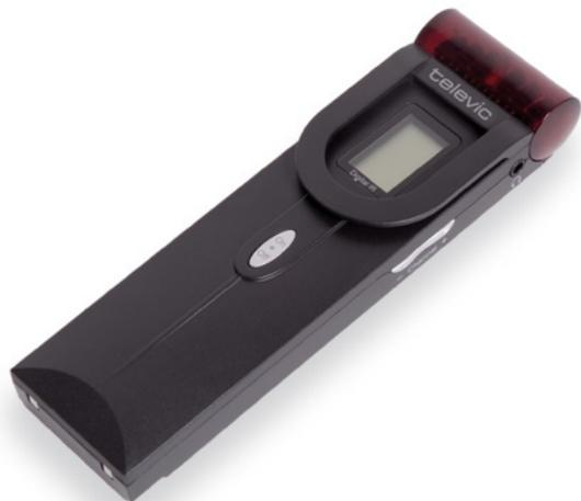
Переводчик переводит слова докладчика, аудио-сигнал распространяется по залу с помощью модулированного ИК-излучения, и делегаты прослушивают речь на выбранном языке с помощью ИК-приемника с наушниками.
