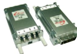
Передатчик и приемник для передачи цифрового сигнала DVI-D на расстояние до 5 км по одномодовым оптическим линиям связи. Отличаются малыми габаритами, поставляются единым комплектом.
