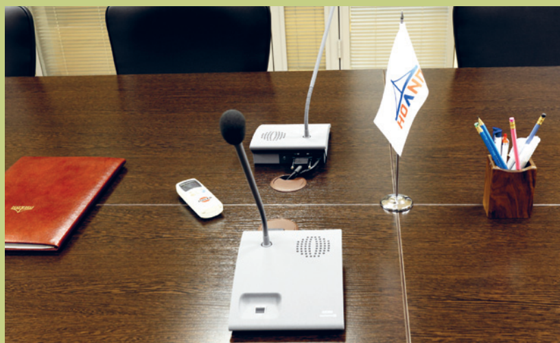
Дискуссионная система на базе оборудования Beuerdynamic для оптимизации воспроизведения звука при работе в режиме ВКС
