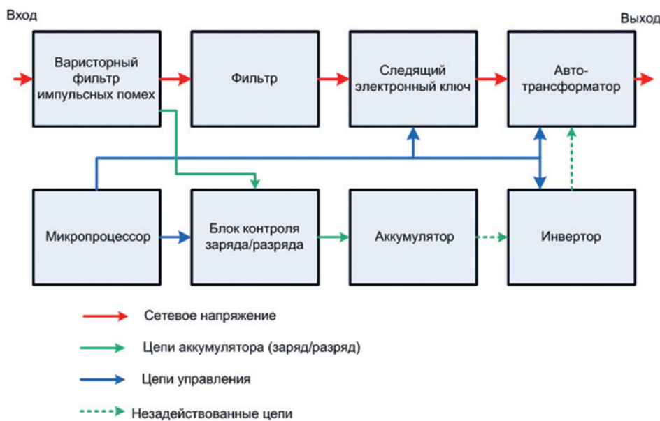
Рис.6а Блок-схема линейно-интерактивного ИБП при работе от сети
