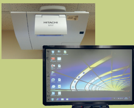
Интерактивная проекционная система (ИПС) на основе ультракороткофокусного проектора Hitachi и широкоформатной интерактивной доски QOMO QWB70WS с диагональю 70" для совместной работы с общим электронным документом
