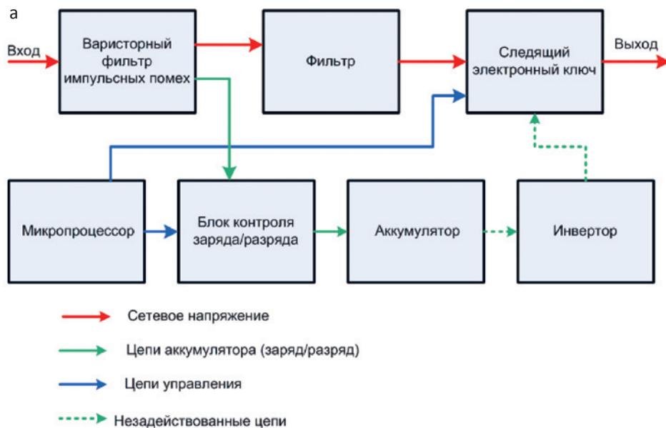
Рис.4а Блок-схема оффлайнового ИБП при работе от сети
