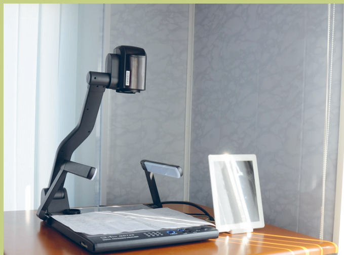
Настольная документ-камера QOMO QD6000 для демонстрации бумажных документов на имеющихся средствах отображения
