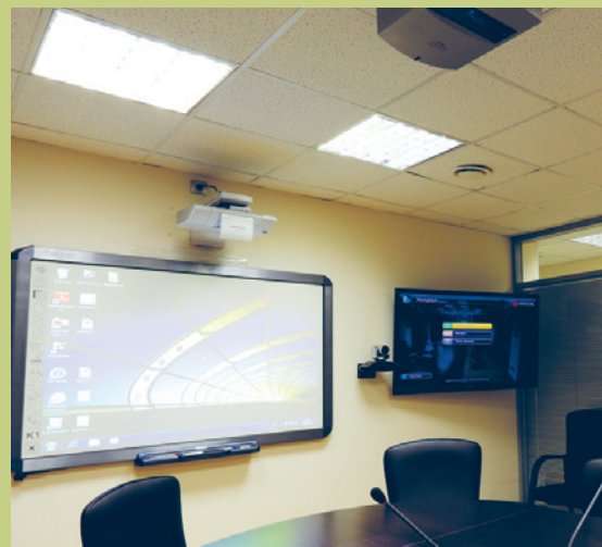
Документ-камера WolfVision потолочного монтажа для вывода на интерактивную доску документов на бумажном носителе
